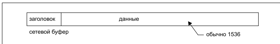
Рис. 1. Схематическое изображение размещения кадра Ethernet в буфере
