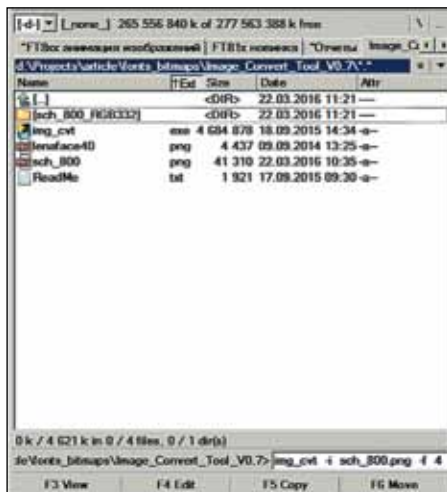
Рис. 12. Процесс преобразования изображения sch_800 в формат RGB332
