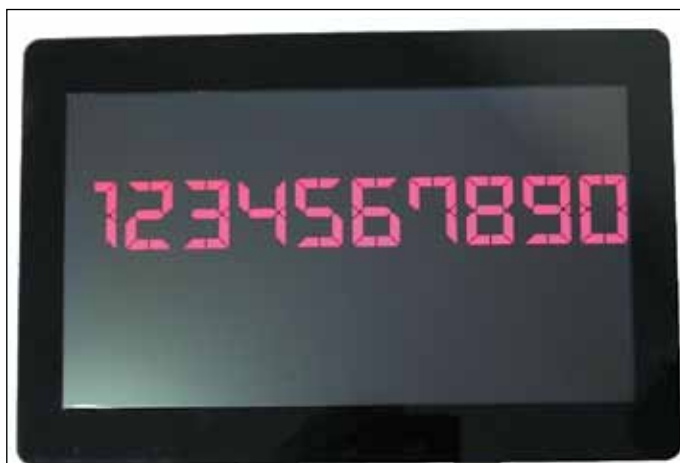
Рис. 6. Вывод на экран символов шрифта digit с размером 70
