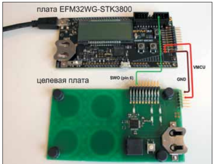
Рис. 9. Подключение EFM32WG-STK3800 для анализа потребления сторонней платы
