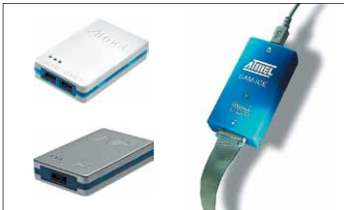
Рис. 5. Аппаратные средства отладки
